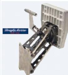
Supporto motore in acciaio inox forgiato con il nuovo sistema "HOT DROP" che unisce alla leggerezza una elevatissima resistenza meccanica. Tavola in plastica. Per motori fuoribordo fino a Kg. 80 o 35 HP 4 Tempi.
