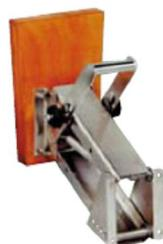
Supporto motore fuoribordo ausiliario in acciaio inox e compensato marino, con 2 molle di richiamo, corsa regolabile in 4 posizioni con bloccaggio antisganciamento. Inclinazione regolabile in 5 posizioni.
