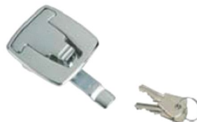
Alzapagliolo a filo in ottone cromato, fissaggio con prigionieri, tavella regolabile da mm. 8 a mm. 20. Dimensioni mm. 53x60 50.50124 con serratura 50.50125 senza serratura
